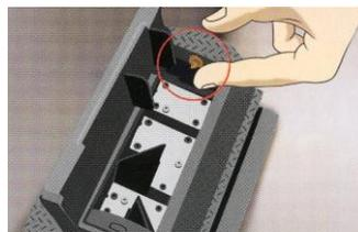
3.) Batteriefach öffnen, Schutzfolien abziehen und Batterien richtig einsetzen.
